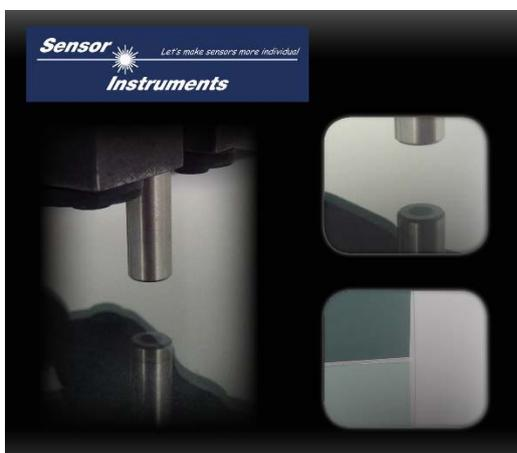
Le front du câble à fibres optiques est dirigé dans le sens vertical vers la surface de verre
